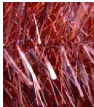
При размещении гирлянды-мишуры на расстоянии нескольких миллиметров от материала, тонкие медные волокна концентрируют электрическое поле статического заряда до тех пор, пока воздух не ионизируется. Ионизированный воздух является проводником и спровоцированный ионообмен приводит к нейтрализации заряда.
