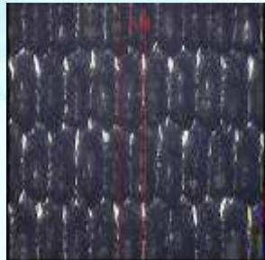
Новая технология гравировки HVP от Sandon Global , это специально разработанный метод гравировки, который улучшает качество и возможности печати плашек, текста и тонких линий. Это действительно многосторонний анилокс, который может использоваться в процессе печати.
